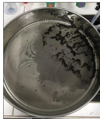
Figure 10 : Echantillon tamisé entre 0,3 et 5 mm
