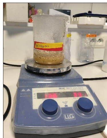
Figure 11: Oxydation d'un échantillon sur une plaque chauffante
