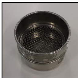
Figure 5 : Tamis 5mm et 300µm superposés
