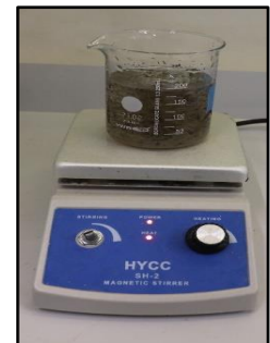
Figure 4 : Digestion d'un échantillon sur plaque chauffante
