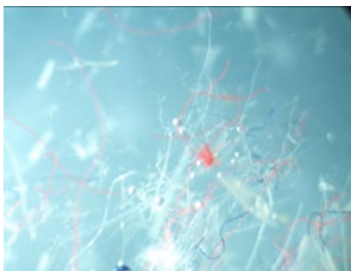
Photo du prélèvement CH-251120-1 présentant un grand nombre de fibres (lumière transmise, grossissement 40X).
