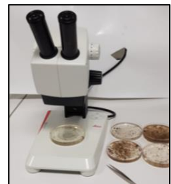
Figure 6. Quantification et identification des MPs sous loupe binoculaire
