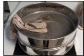
Figure 4. Tamisage d'un échantillon entre 5mm et 300µm
